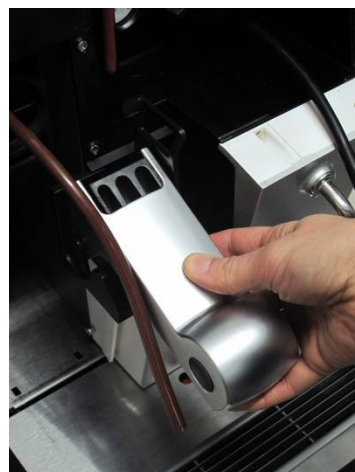
Wysuń wylewkę w lewo i wymyj dokładnie pod kranem
