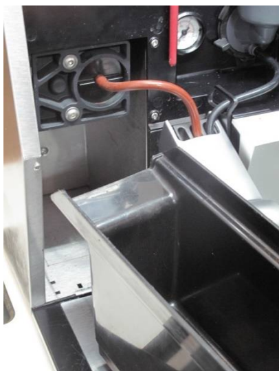
Wyjmij pojemnik na fusy i wylej wodę
