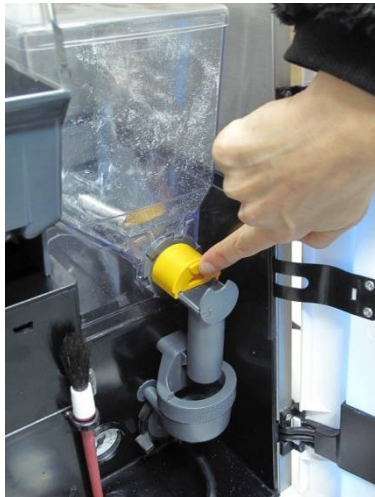
Zamknij wylot pojemnika na mleko Żółta zasuwka do tyłu – „close”
